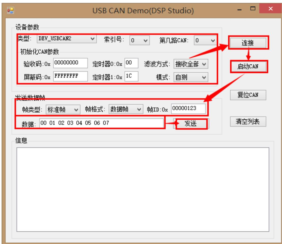
其操作流程，首先在设备参数区选择设备类型，设备索引号，及设备通道号，并且配置好初始化CAN参数，然后点击【连接】以连接USB\_CAN设备，然后点击【启动】，设备就可做
