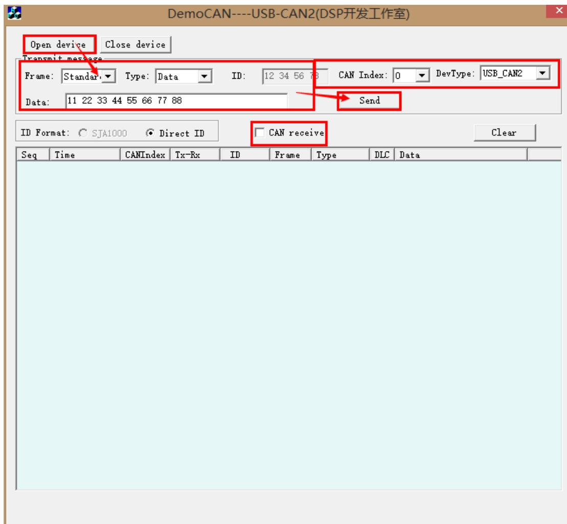
本示例中启动参数使用1Mbps，标准帧，自测模式，当点击“Open device”时，即打开并启动CAN，勾选“CAN receive”来启动接收线程，点击“Send”发送界面配置的CAN数据帧。详情请参见源代码。
