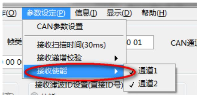
通过改变参数设定菜单下的接收使能下的相关通道勾选状态，来打开通道1及通道2的接收。
