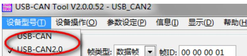
在菜单栏选择“设备型号”下拉菜单中对应的设备型号, 其中: “USB-CAN”为单通道 USBCAN 适配器, “USB-CAN2.0”为双通道 USBCAN 适配器。本公司所有型号产品都选“USB-CAN2.0”。
