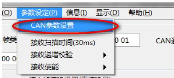
USBCAN 适配器的每个通道有一组独立参数，可独立设置并独立运行，在参数设置界面中通过选择“CAN 通道”来改变当前要修改的目标通道参数：
