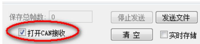
勾选“打开 CAN 接收”选项后，开始接收已使能了的 USBCAN 适配器特定通道上的数据。
