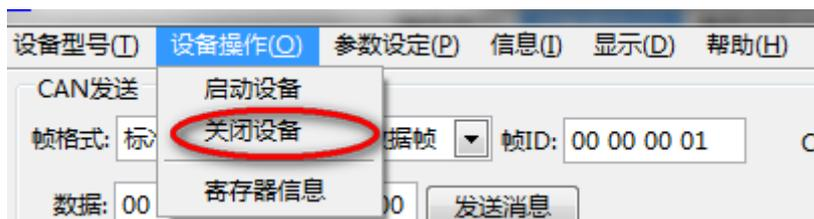
在菜单栏选择“设备操作”下拉菜单中的“关闭设备”，关闭已打开的 USB-CAN 适配器。
