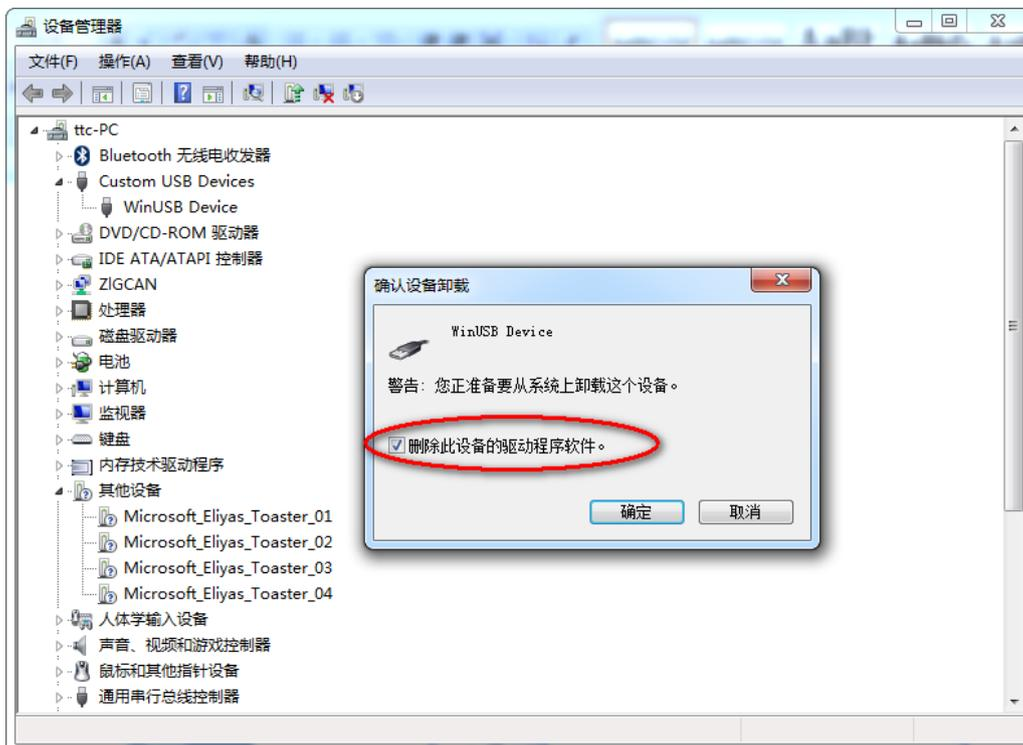
3、卸载完驱动程序，重新插拔一下USB设备。
