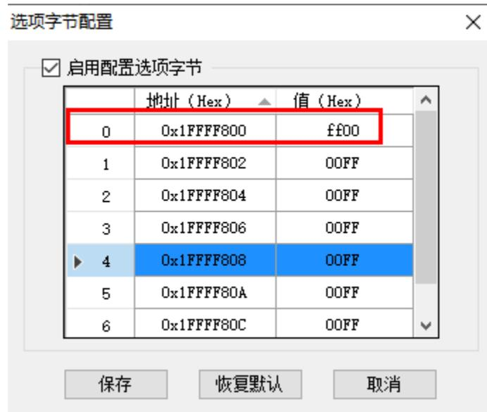
图 2.13-7 选项字节文件内容填到下载器上位机配置界面
