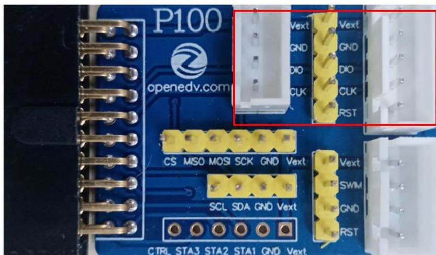
图 1.1 3 P100 脱机下载器配套转接板
