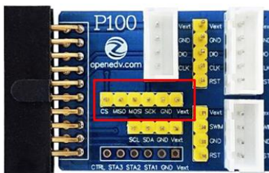
图 1.1-3 P100 脱机下载器配套转接板 SPI 接口位置
