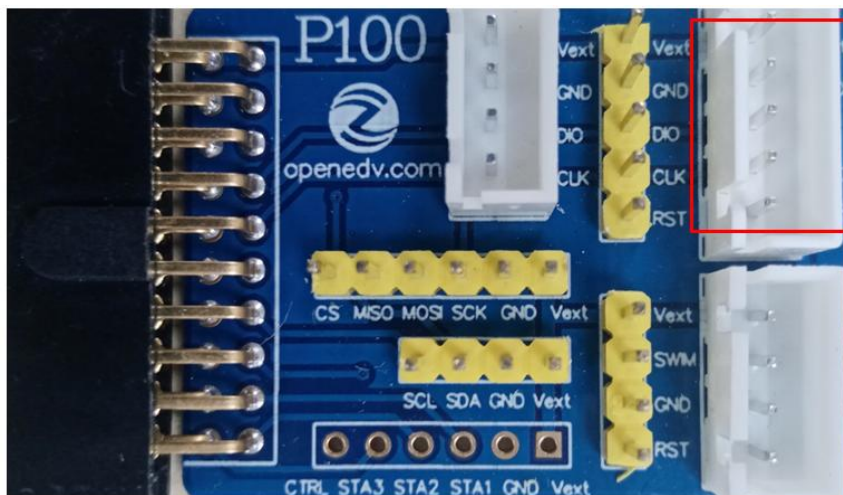
图 1-3 P100 脱机下载器配套转接板 N76E 接口位置
