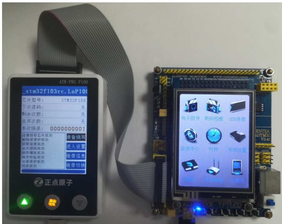
图 3-16 成功烧录开发板正常运行代码
